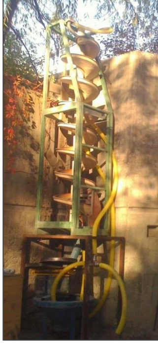
Şekil 6.1: Mineral Deposit A87D türüne ait bir spiral zenginleştirici
