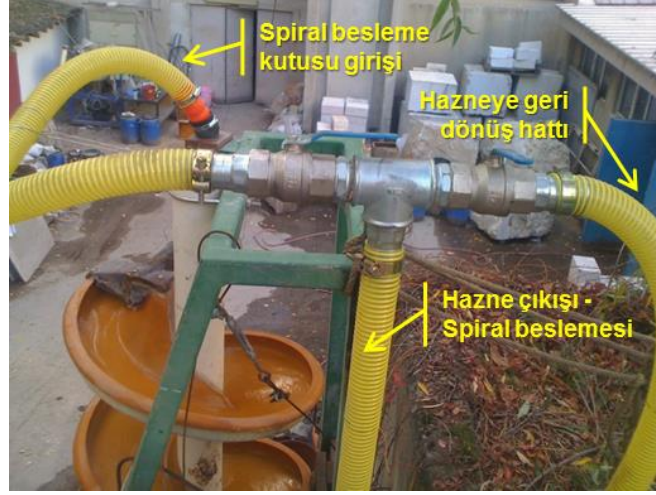
Şekil 6.4: Spiral zenginleştiriciye ait besleme kolları
